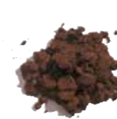
Filterkuchen nach elektroflotation
